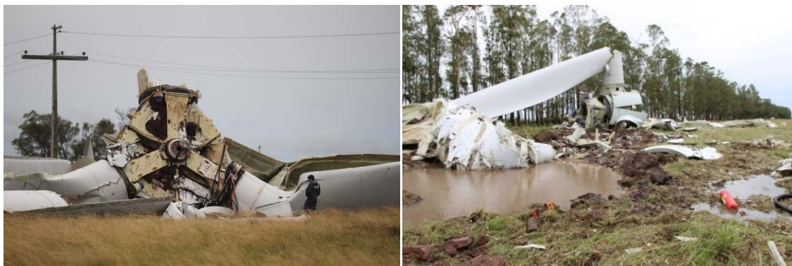
Figura 1.2 – Turbinas eólicas do Parque Eólico de Cerro Chato, no município de Santana do Livramento (RS), destruídas após o vento atingir a velocidade de aproximadamente 29 m/s ocorridas entre as 19 e 21 horas do dia 20 de dezembro de 2014. Fotos: Marcelo Pinto, Jornal A Plateia. Disponível em: < http://fotospublicas.com/temporal-causa-estragos-no-parque-eolico-de-santana-livramento-no-rio-grande-sul/ >. Acesso em: 15/01/2015.
