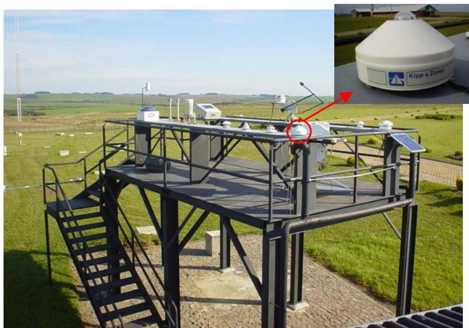
**Figura 4.5:** Plataforma radiométrica do Observatório Espacial do Sul, suportando os equipamentos do projeto SONDA e os sensores de radiação ultravioleta e ozônio do PMOA. No detalhe, o piranômetro *CM21* montado em seu acessório de ventilação.
