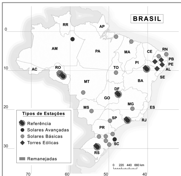
Figura 9 - Mapa de localização das estações da Rede SONDA. Além das Torres Eólicas, as Estações de Referência possuem sensores para coleta de dados eólicos.
