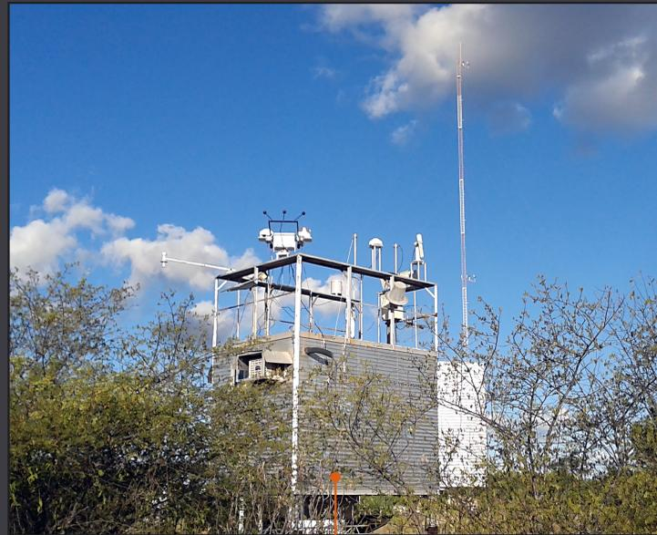
*Estação da rede SONDA instalada no município de Petrolina, Pernambuco, em parceria com a EMBRAPA Cerrado. A estação dispõe de sensores de irradiação global horizontal, direta normal, difusa e onda longa, assim como sensores de temperatura, humidade, precipitação, velocidade e direção do vento.*
