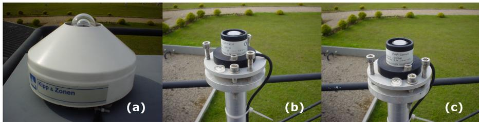
Figura 1 – Sensores instalados na estação de referência SONDA-SMS, localizada no Observatório Espacial do Sul – OES/CRS/CIE/INPE-MCT, em São Martinho da Serra, RS, Brasil. (a) Piranômetro CM 21 (Kipp & Zonen); (b) Luxímetro LUX LITE (Kipp & Zonen); (c) sensor PAR LITE (Kipp & Zonen).
