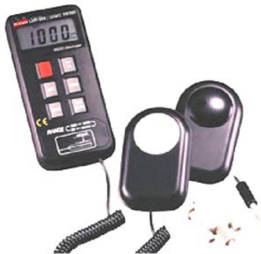
**Figura 2.** Luxímetro LDR-380 utilizado nas medidas de campo realizadas para validação do algoritmo e avaliação da influência da nebulosidade e relevo na relação entre iluminância natural e ângulo zenital solar.
