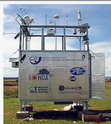
O módulo SONDA é composto de estrutura de suporte aos sensores instalada acima do container que abriga computador, nobreak, datalogger e equipamentos de comunicação responsáveis pelo gerenciamento dos dados coletados.
